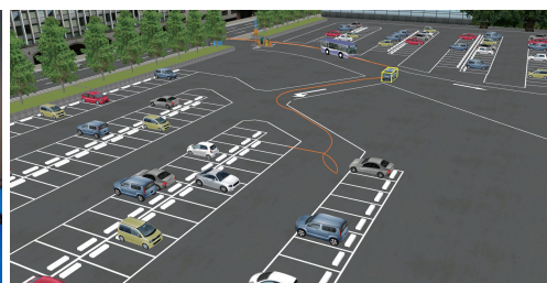
▲ UC-win/Road と駐車場作図システム、車両軌跡作図システムの連携による駐車シミュレーション（右）
